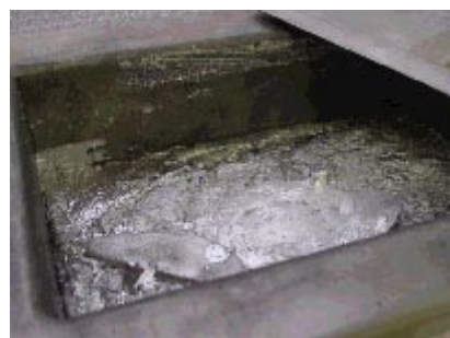
Figura 5 – "Alloy" sendo derretido em equipamento específico
