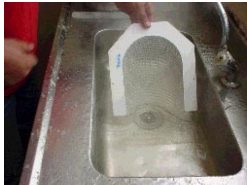
Figura 24 – Máscara termoplástica em água quente
