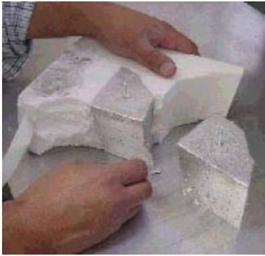
Figura 33 – Proteção sendo retirada da moldura
