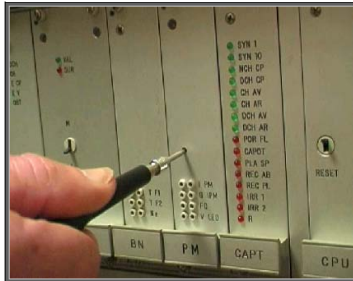
Figura 50: Localização do potenciômetro regulador da frequência da fotomultiplicadora.
