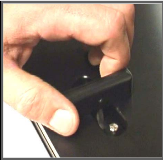
Figuras 42 e 43: Fechamento da placa superior e abertura do obturador proporcionando um sinal diferente de zero na leitura.
