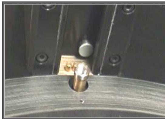
Figura 38: Posicionamento da copela sobre o dedo de descarregamento.
