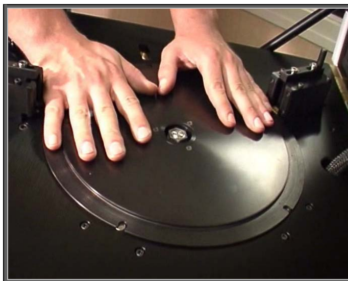
Figura 17: Verificação da tensão do disco e posicionamento.
