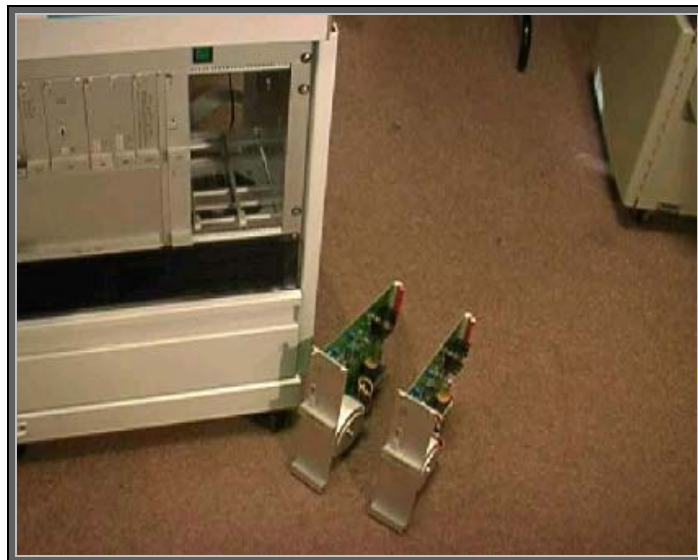
Figura 46: Retirada das placas de alimentação dos Fornos.
