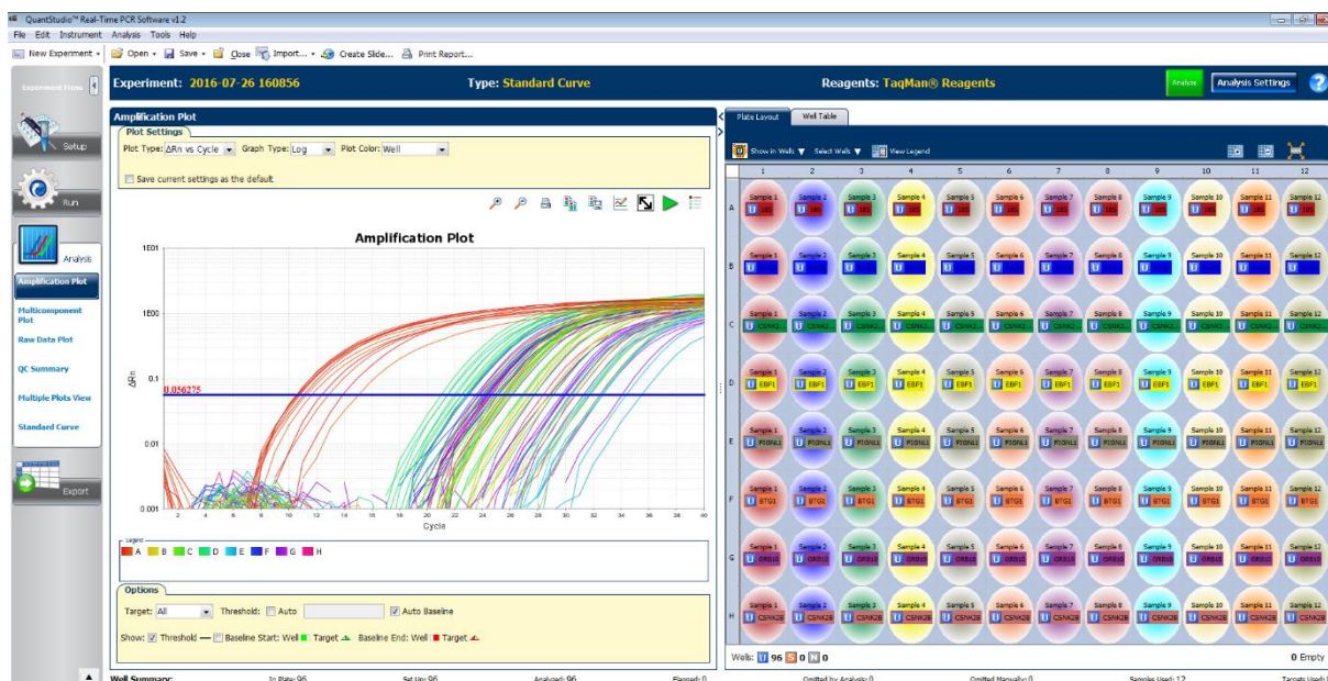
Figura 4.5. Exemplo de reação processada pelo programa QuantStudio Real-Time PCR . A figura demonstra um exemplo de reação, usando TaqMan , analisada pelo programa. À esquerda: gráfico gerado, em função logarítmica, pelo sinal de fluorescência obtido em cada ciclo com threshold determinado (linha azul). À direita: representação do posicionamento de cada alvo e amostra nesta placa.
