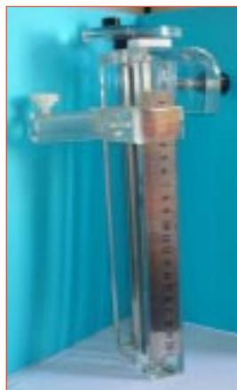
**Figura 19.** Protótipo PQRT e o suporte para sistema postal para CQ em feixes de elétrons
