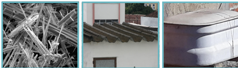
Fibra de amianto e exemplos de uso na indústria da construção civil (telhas e caixas d'água).
