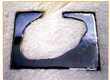
Figura 4.8 - Forma de poliespuma rellena con *cerrobend*<sup>®</sup> derretido
