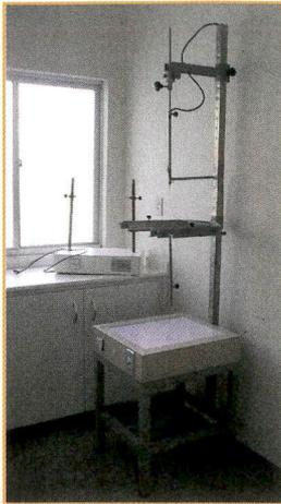
Figura 4.9 - Cortador de poliestireno para bloques que serán usados con haces de fotones
