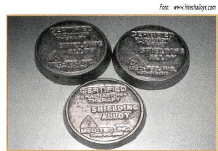
Figura 4.7 - Bloques comerciales de *cerrobend*<sup>®</sup>
