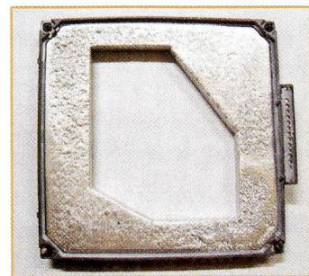
Figura 3.19 - Bloque de protección para tratamiento com feixe de elétrons
