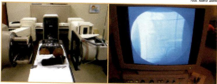
Figura 6.16 - Simulador de cuerpo humano posicionado en el simulador convencional para definir los campos laterales (izq.); y fluoroscopia para definición de los límites y del centro del campo lateral de irradiación (der.)
