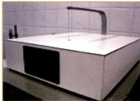
Figura 4.10 - Cortador de poliestireno del tipo simple, usado para confeccionar protecciones para haces de electrones.
