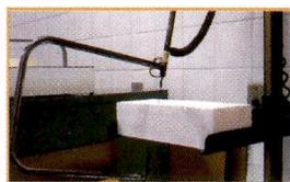
Figura 4.40 - Detalle del hilo metálico del cortador de poliespuma
