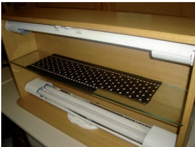
Figura 8 – Sistema criado pelo SQRI para alvejamento de dosímetros OSL
