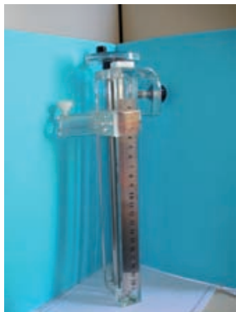
Figura 22 – Protótipo PQRT e o suporte para sistema postal para controle de qualidade em feixes de elétrons
