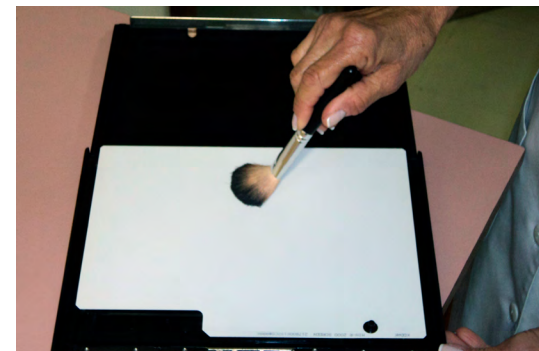
Figura 81. Limpeza de chassi com pincel
