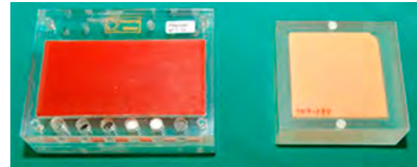
Figura 89. Simuladores radiográficos utilizados para avaliar a qualidade da imagem mamográfica
