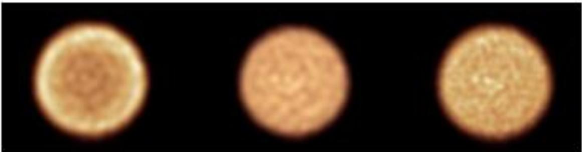
**Figura 19:** Uniformidade Tomográfica obtida com o simulador cilíndrico homogêneo. Imagem sem correção de atenuação, mostrando a perda de sinal com o aumento da profundidade (esquerda). Imagem corrigida pelo TC, mostra boa uniformidade, não havendo perdas de sinal com a profundidade (centro). Imagem corrigida pelo método de Chang, demonstrando não haver perda de sinal com a profundidade, entretanto se mostra mais ruidosa que aquela obtida com a correção pelo TC (direita).
