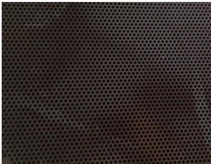
**Figura 7:** Vista aproximada de um colimador HEGP, onde podem ser vistos os orifícios de passagem preferencial dos fótons e as paredes que os separam (septos). Imagem gentilmente cedida pelo Dr. J. Wagner E. da Silva.
