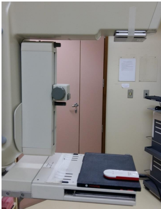
Figura 5 - Posicionamento do detector para o teste da linearidade.
