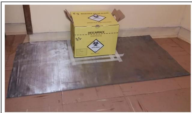
**Figura 4.** Manta de chumbo posicionada abaixo do coletor de perfurocortantes para os ensaios sem meio absorvedor-espalhador.
