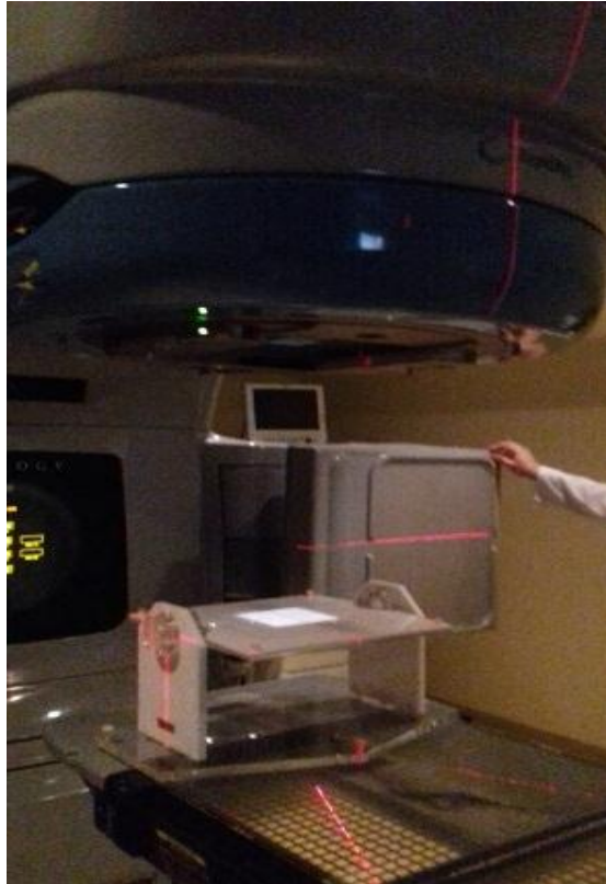
Figura 11. Físico acionando o sistema-anti-colisão
