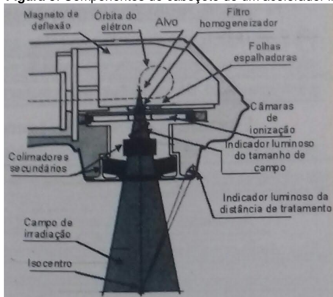
Figura 5. Componentes do cabeçote de um acelerador linear.
